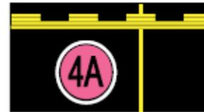
condiciones de escasa visibilidad como puntos de posición en las calles de rodaje.
