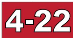
Este letrero/ señal se coloca conjuntamente con la señal de Punto de Espera ubicada en las intersecciones de las calles de rodaje con la pista.
